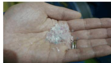
リサイクルに用いる再生材料。再度溶解し、エアセルマットへと再び生まれ変わります。
